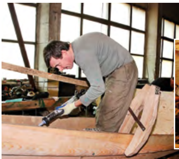
Герметик чем-то напоминает вар, которым раньше замазывали швы
